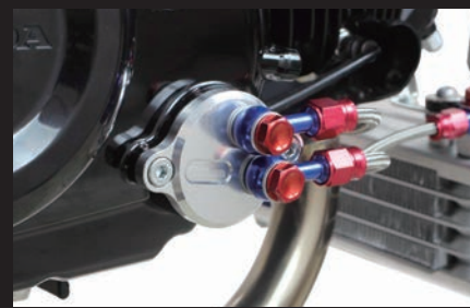
装着写真(オイル取り出し口)
