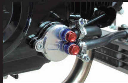
装着写真(オイル取り出し口)
