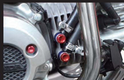
装着写真(オイル取り出し口)
