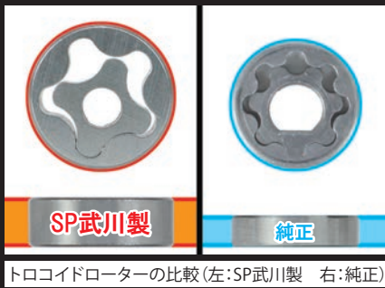
トロコイドローターの比較(左:SP武川製 右:純正)
