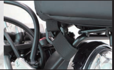
バッグ本体のナイロンベルトでSP武川製フロントキャリアに固定。ナイロンベルト(面ファスナー付き)をDリングに取り付け、固定補助。
