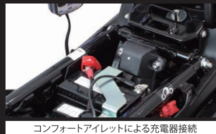
コンフォートアiletによる充電器接続
