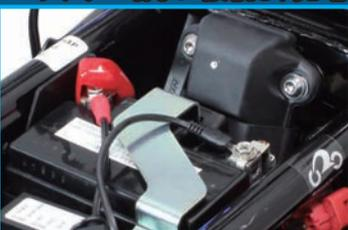
付属のコンフォートアイレットをバッテリー端子に固定し、充電を行います。コンフォートアイレットをオートバイのシート下やカウリングからアクセスできるようにすることで、外装等を取り外すことなく、充電器側のコネクタを接続でき、簡単にバッテリー充電とメンテナンスが行えます。コンフォートアイレットにヒューズとヒューズボックスを装備
