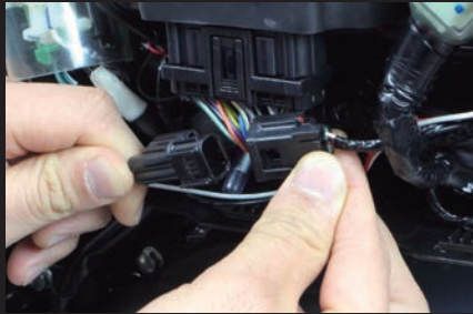
専用ハーネス付属により、配線加工の必要がなく、 カプラーオンで取付け可能
