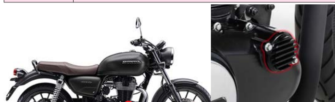
空冷フィンデザインしたオイルフィルターカバーをアルミ削り出しでワンポイントドレスアップ
