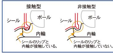
シールとベアリング・内輪部が接触していない為、 シール部の摺動抵抗はありませんが、防水性、防塵性、 特に防水性が、一般に採用されているボールベアリング よりは劣ります。
