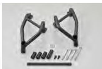
ELIMINATOR/SEのフレームデザインをオマージュしたパイプレイアウト。転倒時の車両のダメージを軽減。取り付けのしやすい左右セパレート構造でマフラーを取り外すことなくエンジンガード装着が可能。剛性UPのため、左右を連結するビームを採用。
