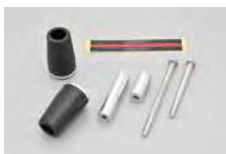
樹脂製パッドとアルミベースの一体構造により十分な強度を確保。転倒時の衝撃を受け流し、クランクケース割れなどの致命的なマシンダメージを最小限に軽減。車種専用適正な張り出しを設定し、エンジンマウントボルトと交換するだけのボルトオン設計。
