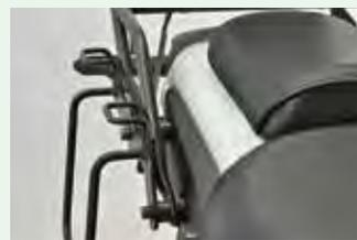
グラブバーキャリア(39583)とサドルバッグサポート(38523/38524)の2点同時装着、または、グラブバーキャリア(39583)とサドルバッグサポート(38523/38524)とバックレストキット(38522)の3点同時装着するために必要です。キャリア取付部と接触しないようにサドルバッグサポートを外側に約15mmオフセットして装着します。片側用なので左右にバッグサポートを装着する場合は2個必要です。
