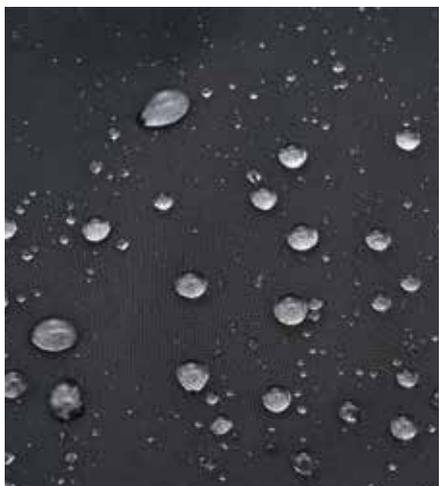
シートとの摩擦が激しい下半身はPVCコートの高耐久性生地を採用。耐水圧20,000mm
