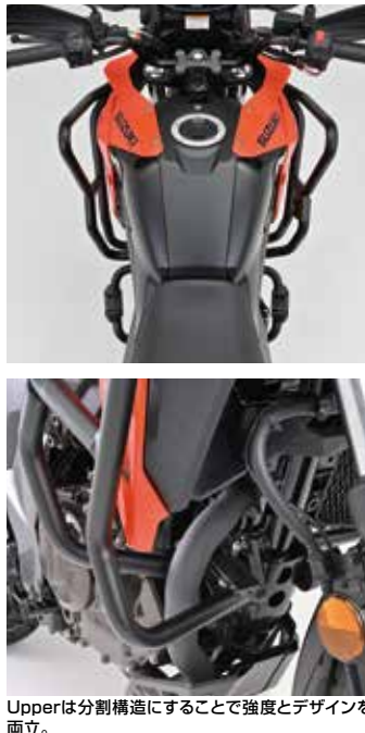
Lowerはマフラーの脱着が不要。純正スキッドプレートとの同時装着も可能です。
