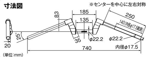
ネオクラシックモデルのカフェカスタムに最適なアルミビレットローハンドル。センターストレート部が一般的ロードモデルと同径のφ22.2仕様を追加しました。アルミ無垢材からの総削り出しブラックアルマイト仕上げ。
