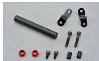
※Ninja400/250 ('18~'19) は汎用のマルチバーホルダー/ステムクランプは取り付けできません。ステムホールは空いていますが、内部が段付き形状でマウントキットが固定できないため取付不可です。車種専用バーホルダー(17862/17861/16801)をご使用ください。
