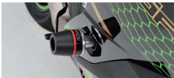
樹脂製パッドとアルミベースの一体構造により十分な強度を確保。転倒時の衝撃を受け流し、クランクケース割れなどの致命的なマシンダメージを最小限に軽減。設定車種にボルトオン設計。補修部品もご用意しております。
