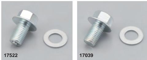
純正同等のスチール製なので脱着時も安心。アルミ製ドレンワッシャー付属。フランジ付きなので汎用のドレンワッシャーが使用可能。マグネット付きは、ネジ先端部のマグネットにオイル中の鉄粉を付着させ、オイルをクリーンにキープします。ボルトの頭の二面幅は14mm。
