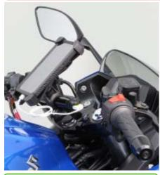
USB 電源付 12V 車専用 出力 5V 2.1A 接続機器を自動で認識し、最適な 充電方式を選択します。 i Phone などの充電にも対応 充電保護機能付の省電力設計
