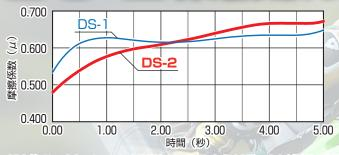
※ SBS 社でシュミレーションによる時速 310km/h から 135km/h に減速時の摩擦係数比較
