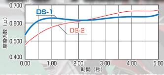
※ SBS 社でシュミレーションによる時速 310km/h から 135km/h に減速時の摩擦係数比較 DS-1とDS-2 のパッドフィーリングは異なりますがキャリパー 左右で異なるDS-1/DS-2 のパッドを装着することが可能です。 サーキットレイアウトや、コースコンディションによってブレ キパッドもセッティング出来るようになりました。
