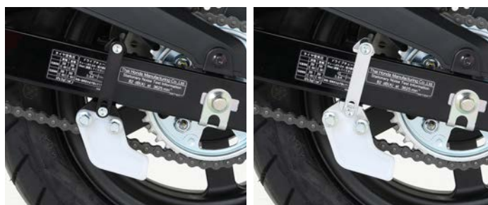
転倒時、チェーンへの巻き込みを防ぐチェーンガード。レースレギュレーションにも対応。
