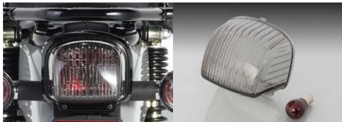
ノーマルテールレンズとバルブの交換で、簡単スモークタイプにチェンジ。
