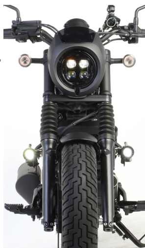
ベストな取付ポジション LED シャトルビームはラジエーター横取付タイプです。
