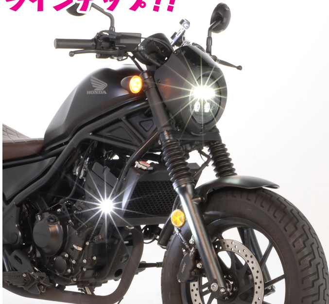
ベストな取付ポジション LED シャトルビームはラジエーター横取付タイプです。
