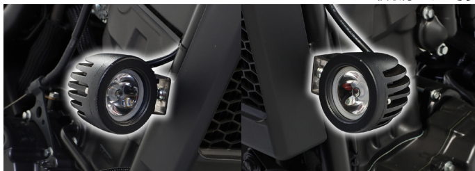
ベストな取付ポジション LED シャトルビームはラジエーター横取付タイプです。
