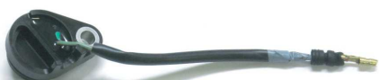
CT125 ハンターカブのスイッチ ※ニュートラルの線しかない為1~4速表示不可
