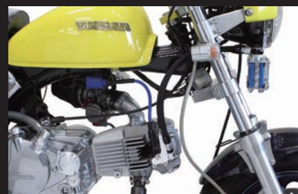
装着写真 (3フィン4オイルライン)
