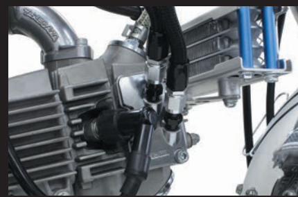
装着写真(オイル取り出し口)
