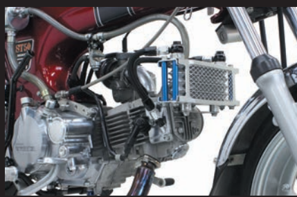
装着写真(4フィン5オイルライン)
