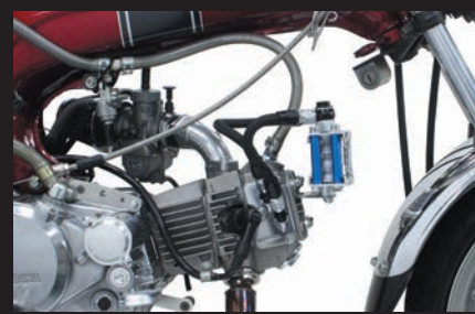
装着写真(3フィン4オイルライン)
