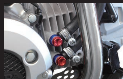
装着写真(オイル取り出し口)
